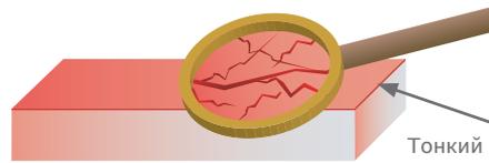
Стабильность и низкий уровень шума при дожде обеспечиваются высокой толщиной материала не только в ребристых листах (с пустотами).
